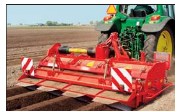
Активные, гребнеобразующие фрезы и пассивные окучники-гребнеобразователи
